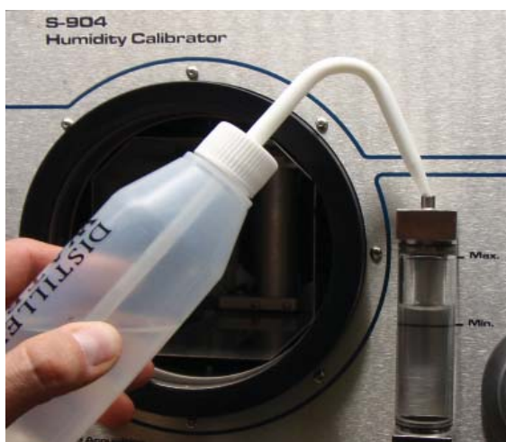
Figure 9 Remplissage du réservoir d'eau
